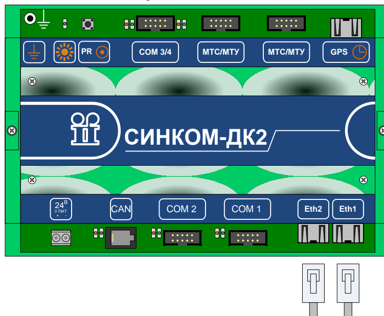
Рис. 5. Подключение каналов Ethernet к контроллеру «Синком-ДК2»
